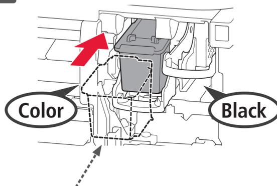
Plaats de cartridge totdat deze niet verder kan. Insira-o diretamente até que ele pare. Insértelo recto hasta que se detenga. Τοποθετήστε το ευθεία μέχρι το τέρμα.
