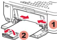
4 Pas de papiergeleider (Paper Guide) aan het formaat van het gebruikte papier aan en open het verlengstuk van uitvoerlade (Output Tray Extension).
